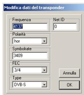
Potete anche richiamare questa funzione con un doppio clic su un transponder. Qui potete cambiare la **frequenza**, la **polarità**, il **symbol rate**, la **FEC** e il **Net ID** di un transponder. Queste modifiche sono valide anche per tutti i canali appartenenti al transponder.
