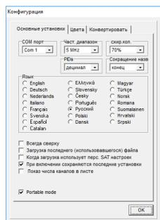
С помощью параметра **частотный диап.** Вы можете задать диапазон, который при импорте из других источников будет отнесен к одному транспондеру. Если у вас есть, например, транспондер 11721 МГц и Вы импортируете канал с частотой 11720 и при этом частотный диапазон выставлен 5 МГц, то новый транспондер не будет образован.
