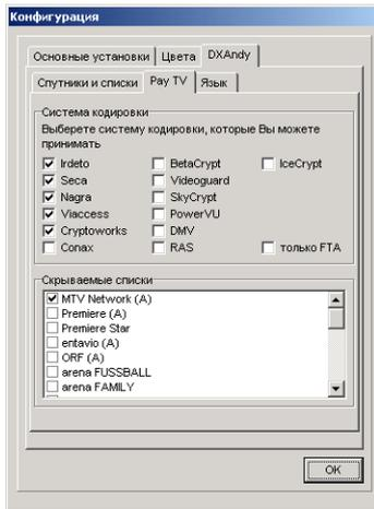
**Система кодировки:** Здесь можно выбрать, какие системы кодировки Вы можете принимать. Каналы с другими кодировками будут скрыты. С помощью "только FTA" все закодированные каналы будут скрыты и останутся только "Free-To-Air" каналы.
