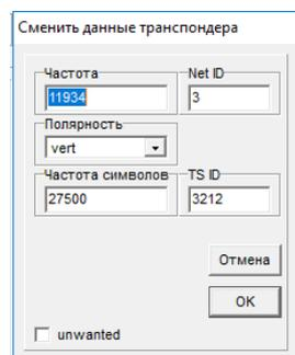
Так же можно дважды кликнуть на транспондер для того, чтобы появилось это окно. Здесь можно изменить **Частоту**, **Полярность**, **скорость передачи**, **FEC**, **NetID** и **TSID** Транспондера, а также ввести **имя** транспондера.
